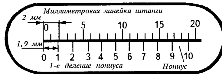
Рис. 63. Шкала штанги и нониус
